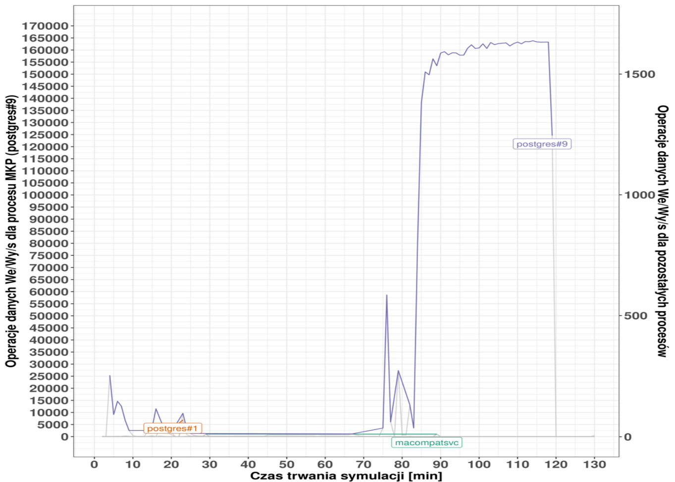
Rysunek 3 Liczba operacji wejścia-wyjścia na sekundę przez aktywne procesy systemowe w trakcie trwania symulacji.
